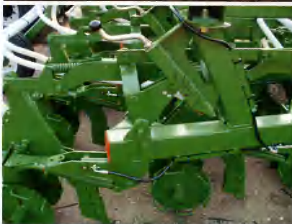
Группы сошников с механизмом регулирования глубины заделки семян
