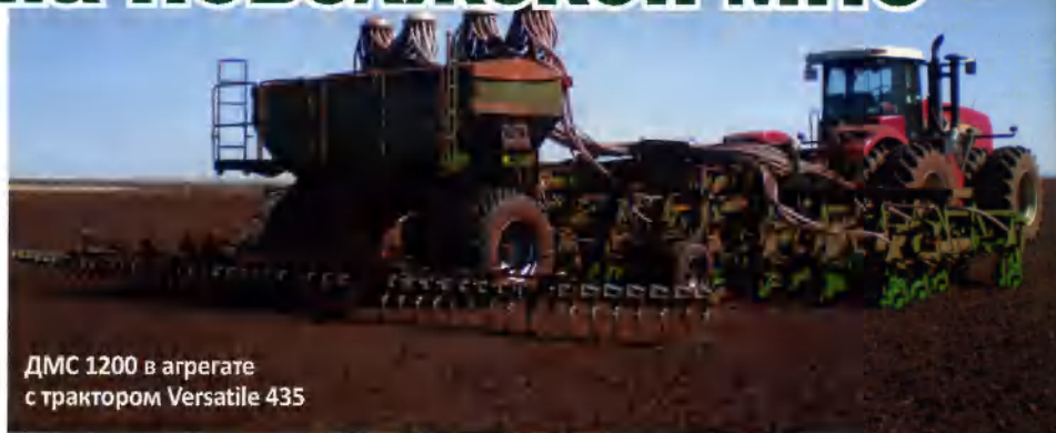
Группы сошников с механизмом регулирования глубины заделки семян
