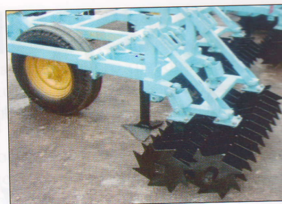
Рабочие органы ОПО-8,5: плоско- режущие лапы и секции зубчатой дисковой бороны
