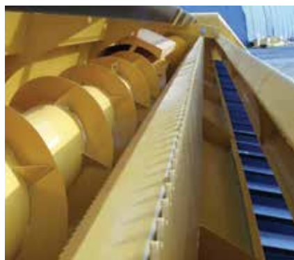
Рабочие органы: лифтеры, обтекатель, режущий аппарат, мотопила, шнек
