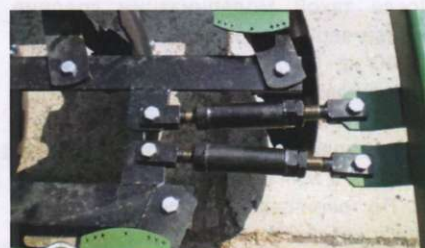
Механизм регулировки угла атаки дисков
