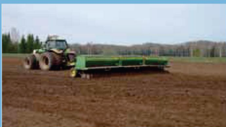
Сеялка зерновая прицепная модели 455 в агрегате с трактором Deutz Fahr L720 в работе
