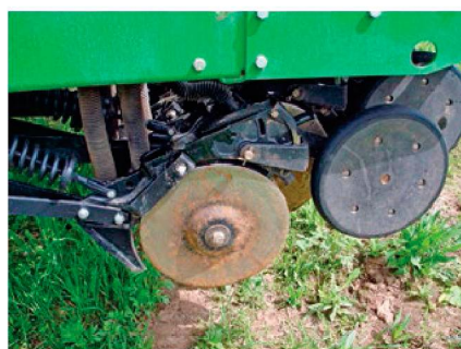
Рабочие органы: двухдисковый сошник и прикатывающее колесо
