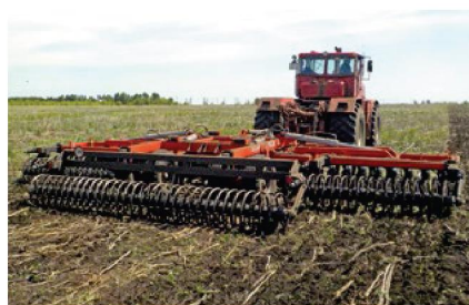
Борона дисковая модернизированная БДМ-8х2ПК в работе с трактором К-701
