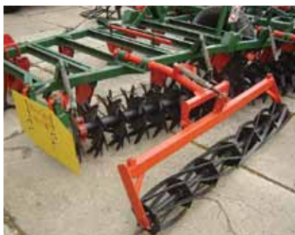
Универсальность КПИР-7,2 обеспечивают 19 плоскорежущих лап и 4 секции батарей игольчато-ножевых дисков и катков.
