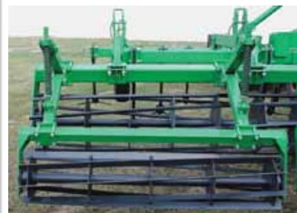
Стрельчатые плоскорежущие лапы и винтовые ребристо-планчатые катки культиватора «Степняк-7,4» создают условия для сохранения влаги.
