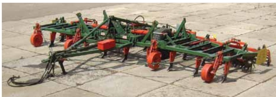
Культиватор-плоскорез игольчато-роторный КПИР-7,2 лучше применять с тракторами класса 3.
