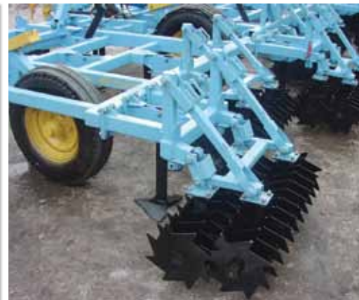
Рабочие органы ОПО-8,5 – плоскорежущие лапы и секции зубчатой дисковой бороны.
