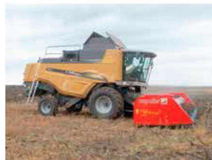
Жатка для уборки подсолнечника «HE 7500» в работе в агрегате с самоходным зерноуборочным комбайном Challenger CH 647C
