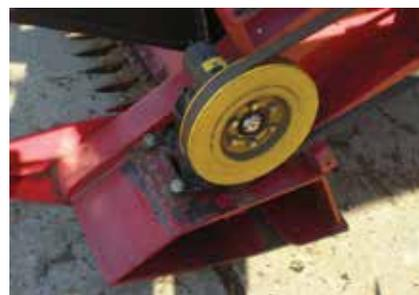
Привод режущего аппарата
