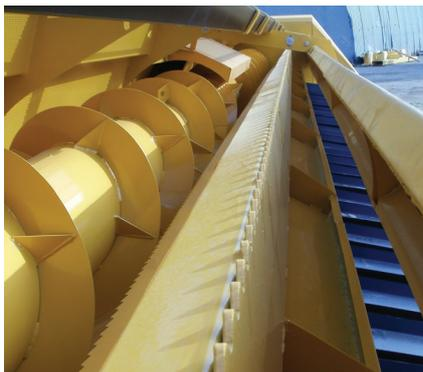
Рабочие органы: лифтеры, обтекатель, режущий аппарат, мотовило, шнек
