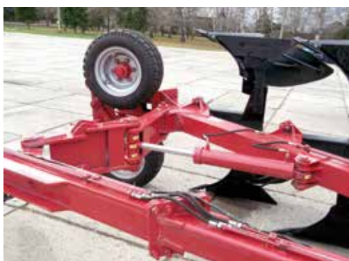
Механизм перевода поперечной балки и передних опорных колёс в рабочее положение
