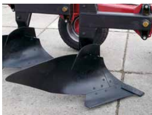
Корпуса плуга полувинтового типа с углоснимками
