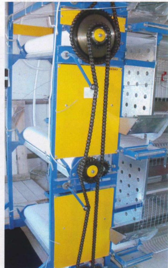
Рис. 6. Приводная станция удаления помёта
