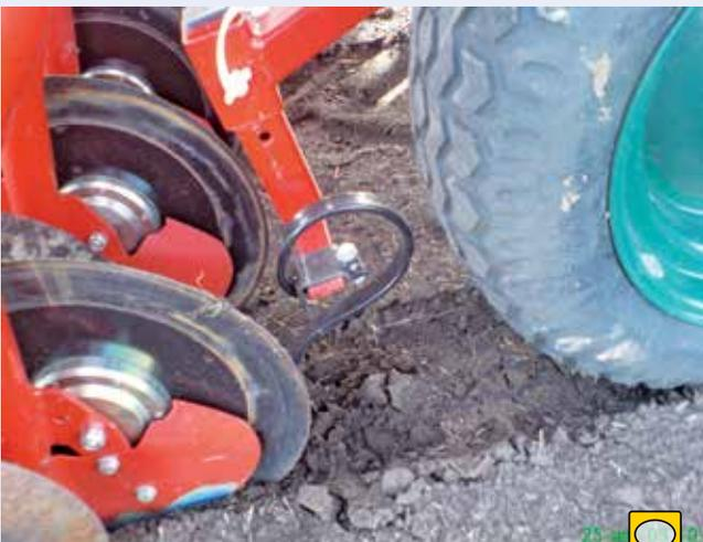
Сзади опорно-приводных колес установлены следорыхлители
