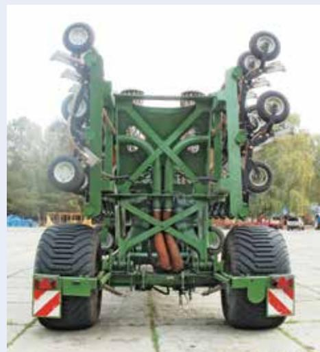
Концепция складывания с шириной захвата до 15 м при транспортной ширине всего 3 м
