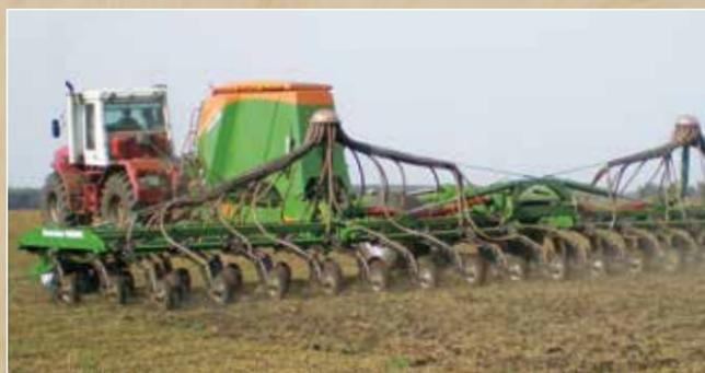
Пневматическая сеялка прямого посева Amazone Condor 15000
