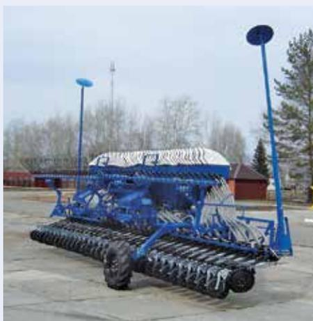
Сеялка имеет двухсекционный пирамидальный семенной бункер, внутрь которого вмонтированы распределительные головки пневмосистемы
