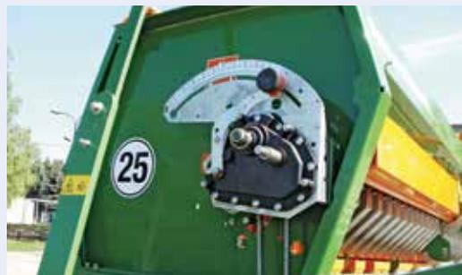
Редукторы Vario для посевного материала и удобрений обеспечивают быструю бесступенчатую настройку нормы высева
