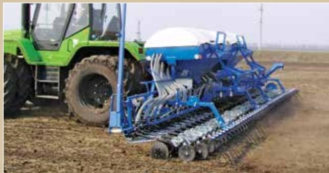
Зерновая пневматическая сеялка «Агро-маш» СЗП 800
