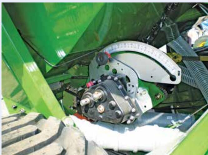
*Редукторы Vario для посевного материала и удобрений обеспечивают быструю бесступенчатую настройку нормы высева*
