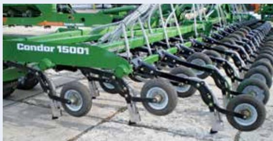
На сеялке Condor-15000 установлены долотовидные сошники с индивидуальным ведением по глубине. Гибкое соединение элементов рамы и сошника достигается за счет известных пружинных демпферов
