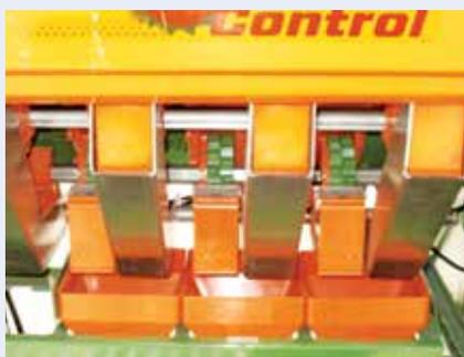
Система дозирования D9 оптимизируется по свойствам подачи и продольного распределения. Это достигается за счет комбинации из высевающей катушки Control 80 мм с новым корпусом дозирующей катушки и заслонки
