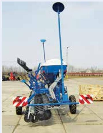
Сеялка имеет жесткую раму и оснащена приспособлением для продольного движения для транспортировки по дорогам
