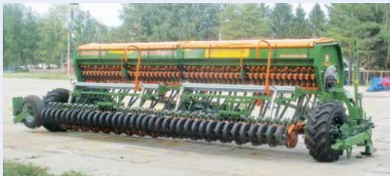
Благодаря продольному шасси машина имеет транспортную ширину 2,75 м
