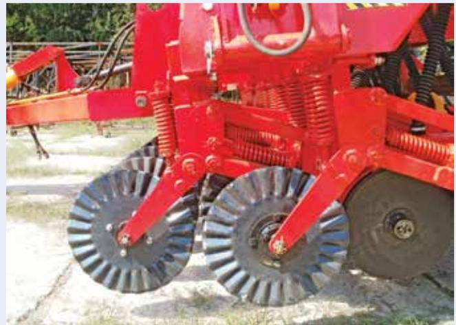
*Глубина заделки семян регулируется индивидуальными опорными каточками для каждого сошника и прорезными дисками, работающими усилием нажатия пружин на каждом режущем узле*
