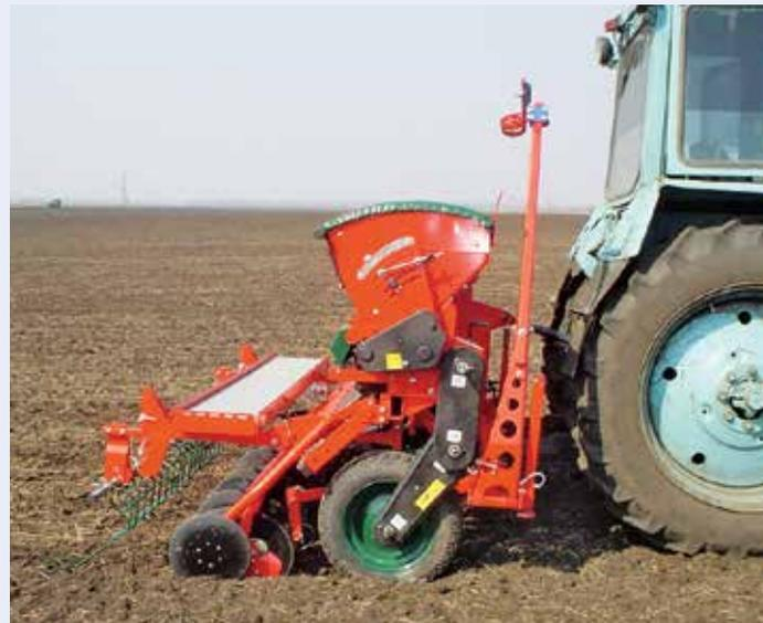
Рабочими органами являются однодисковые сошники, закрепленные на стальных семяпроводах, и пружинный выравниватель
