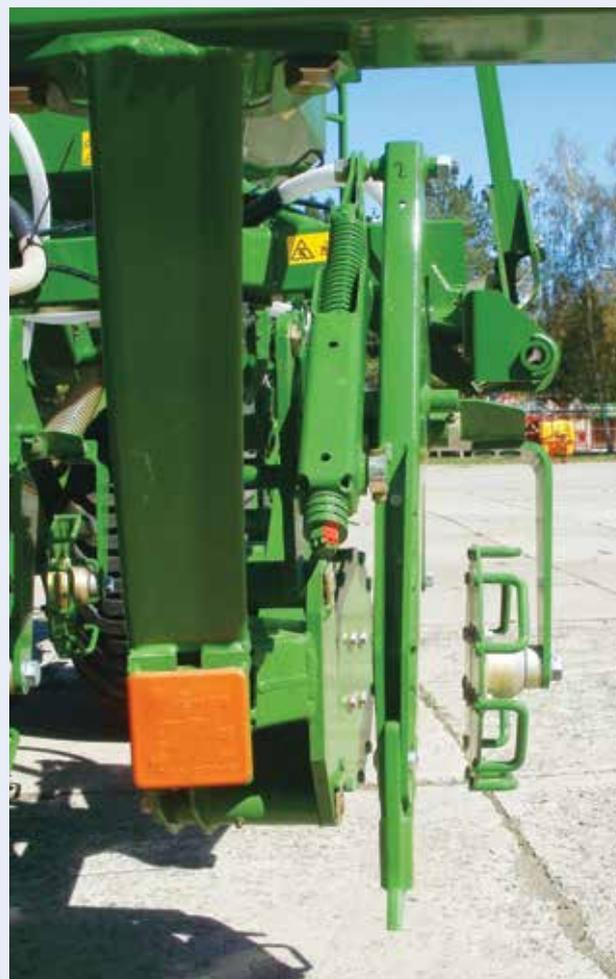
*Рамочный каток состоит из отражающих дисков и рамок, которые служат в качестве опорных элементов. Изготовленный из цельного куска методом литья, он обладает высокой износостойкостью*
