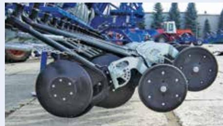
Механическая регулировка давления сошников, с возможностью регулировки давления каждого сошника
