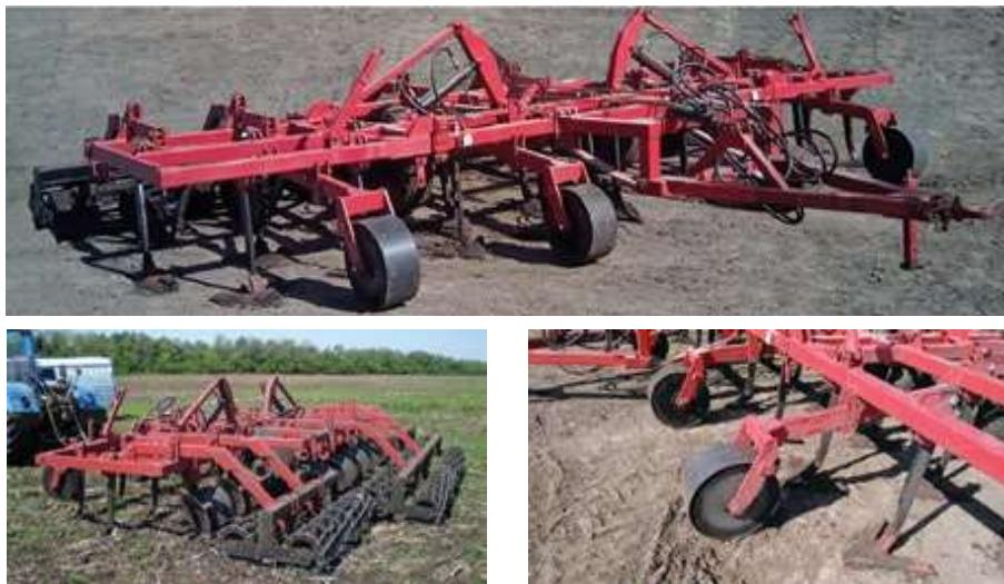
**Назначение.** Для основной, предпосевной и паровой обработки почвы с одновременным выравниванием и прикатыванием поверхности почвы при ее влажности до 30% и твердости до 3,5 МПа.
