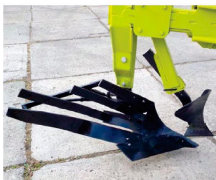
Рабочие органы: предплужник и корпус с полосовым отвалом
