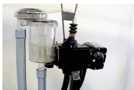
Блок управления, пульсатор, приемник
