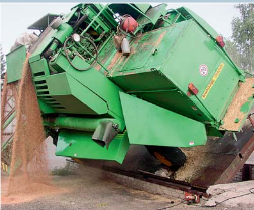
Nicht nur die leere Maschine, sondern auch der Mähdrescher mit vollem Korntank muss die Prüfung auf Stabilität bestehen.
