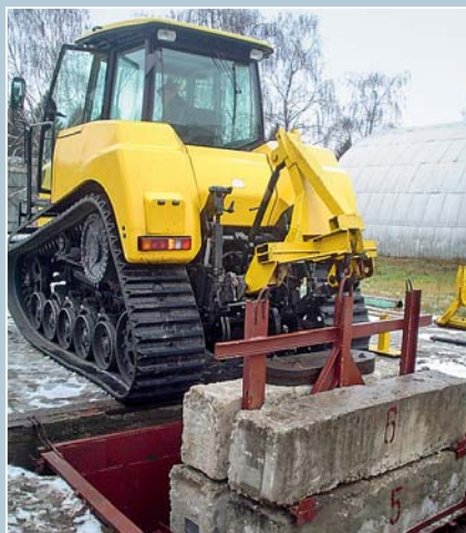
Der Anbaubock muss eine Stunde lang die Last von bis zu 100 kN aushalten. Die maximale Höhe beträgt 1,50 m.
