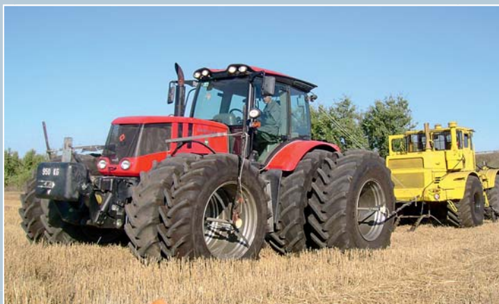
Bei Traktoren mit Zugkräften bis 200 kN wird neben der Zugleistung auch der Schlupf und Wirkungsgrad errechnet. Fotos: AIST, Borisov
