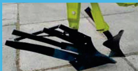
Рабочие органы: предплужник и корпус с полосовым отвалом
