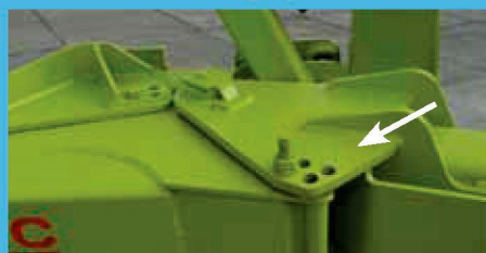
Механизм регулировки ширины захвата каждого корпуса
