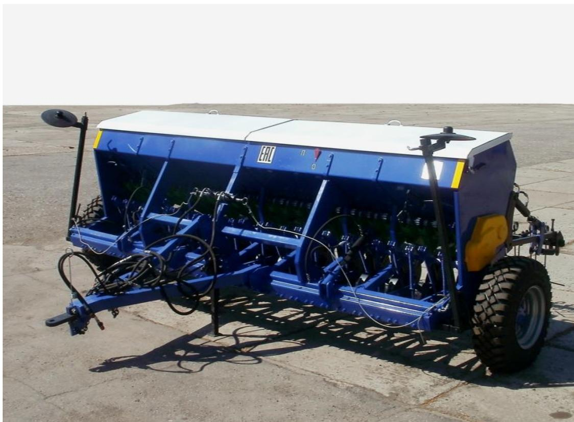
**Сеялка зерновая механическая СЗМ-3,6Б**
