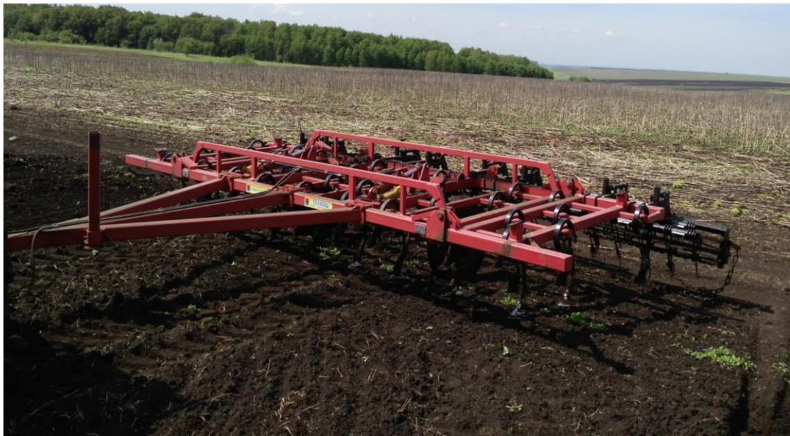
**Культиватора для сплошной обработки почвы КПМ-6**
