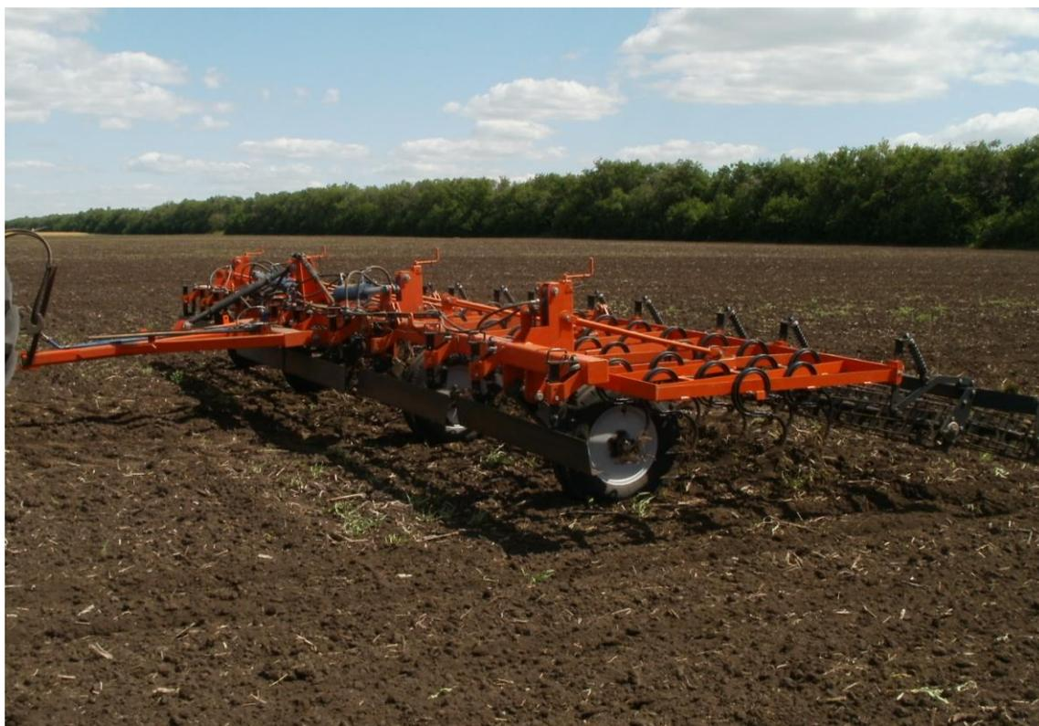
**Культиватор предпосевной обработки почвы КПО-9.**
