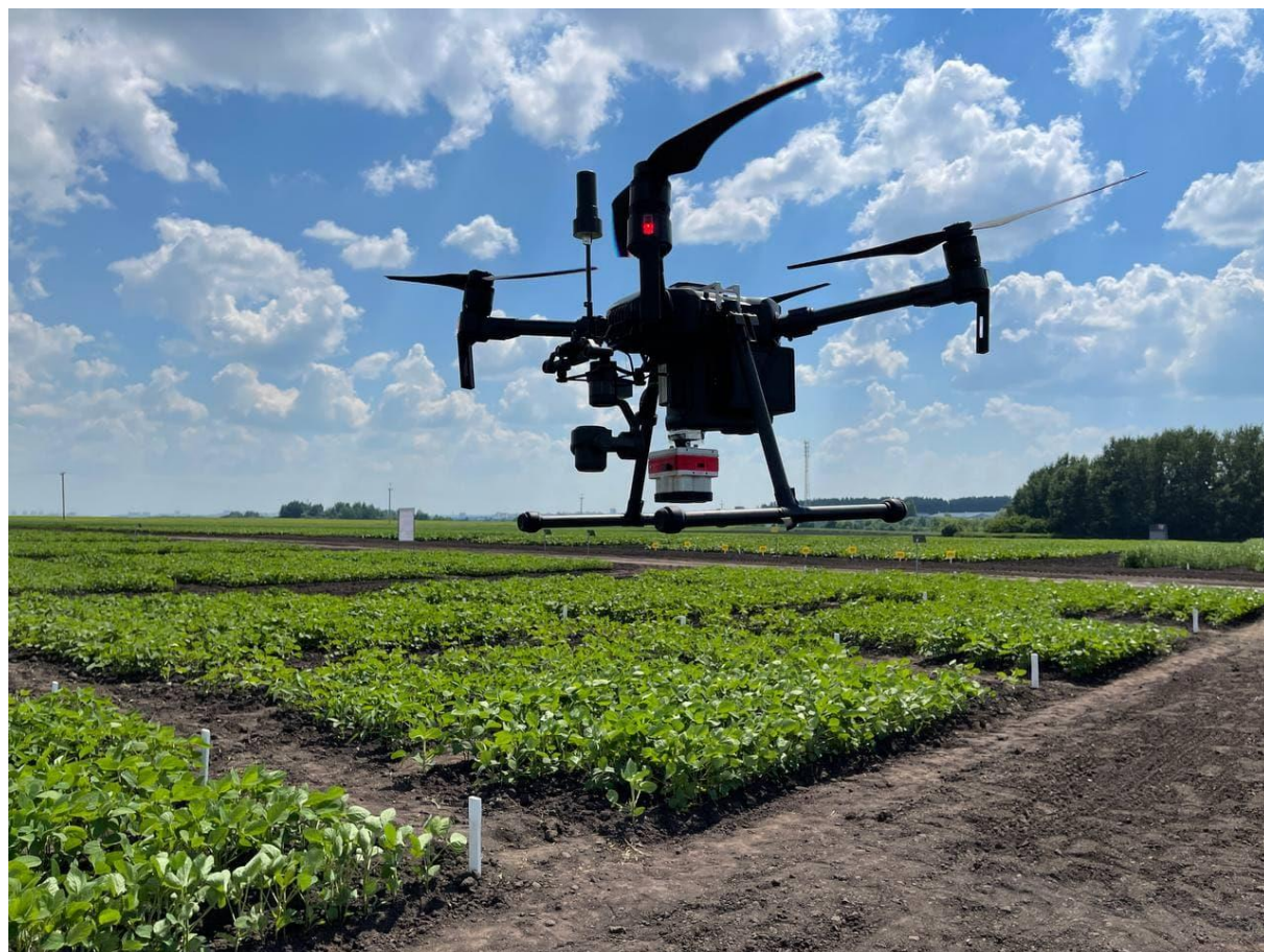
БВС DJI Matrice 200 v2 с ГНСС приёмником
