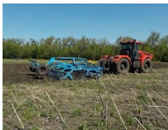
Агрегат дисковый «TIGARBO» АДС-6 в агрегате с трактором К-735М, на измельчении стерни подсолнечника
