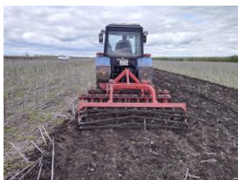
Борона дисковая навесная БДН 2,4х2 в агрегате с трактором МТЗ-82 на обработке стерни подсолнечника
