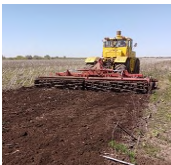
Борона дисковая навесная БДН 6х2 в агрегате с трактором К-701, на обработке стерни подсолнечника
