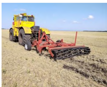
Плуг чизельный навесной ПЧН-3,0КТ в работе в агрегате с трактором К-700А
