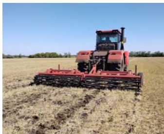
Плуг чизельный навесной ПЧН-5,0КТ в работе в агрегате с трактором К-742МСт1
