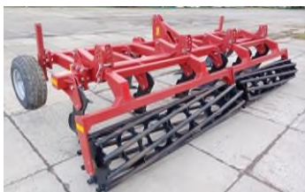
Плуг чизельный навесной ПЧН-5,0КТ, опорные трубчатые катки
