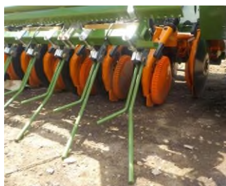
Сеялка D9 6000-ТС. Рабочие органы (сошники, выравниватели).
