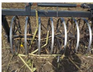
Борона БМ-4,5. Батарея кольцевых рабочих органов
