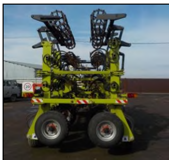
Культиватор модульный прицепной КМП-14 в транспортном положении
