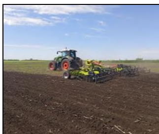
Культиватор модульный прицепной КМП-14 в работе в агрегате с трактором Fendt 933 Vario
