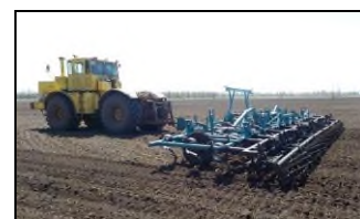
Культиватор полуприцепной комбинированный КМ КПК-12 в агрегате с трактором К-701 в работе
