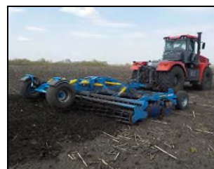
Луцильник дисковый SOFTER 8PS в агрегате с трактором К-739Ст в работе
