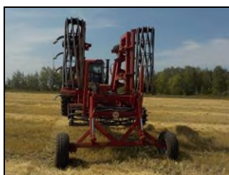
Плуг чизельный прицепной ПЧП-6КТ в транспортном положении
