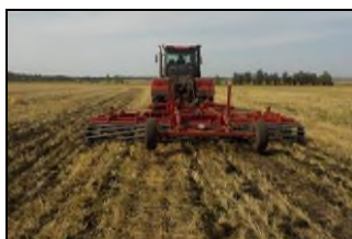
Плуг чизельный прицепной ПЧП-6КТ в работе в агрегате с трактором «Кировец» К-742Ст
