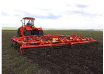
Культиватор «Landmaster-8500» в агрегате с трактором Т-360, на предпосевной обработке почвы
