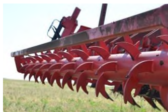
Глубокорыхлитель КАМА TIGER 4 Культиваторный блок, состоящий из двух катков.
