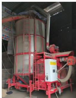
Зерносушилка передвижная, торговой марки «АТМ», модели АТМ-15 в работе
