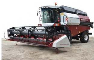
Комбайн зерноуборочный самоходный РСМ-101 "Вектор-410" с жаткой РСМ-081.27.
