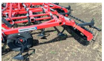
Культиватор «Landmaster-11000». Рабочие органы – стрелчатые лапы на С-образных стойках, каток, пружинная боронка.
