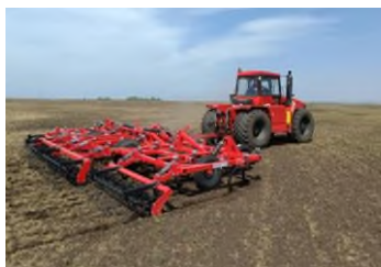
Культиватор «Landmaster-11000» в агрегате с трактором Т-360 на предпосевной обработке почвы
