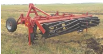
Плуг чизельный навесной ПЧН-4,0КТ, опорные трубчатые катки.
