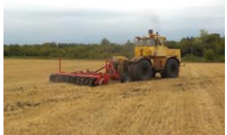
Плуг чизельный навесной ПЧН-4,0КТ в работе в агрегате с трактором К-701
