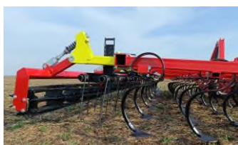
Культиватор «Tillermaster-7200». Рабочие органы – стрельчатые лапы на S-образных пружинных стойках, 2-х рядные пружинные боронки, катки
